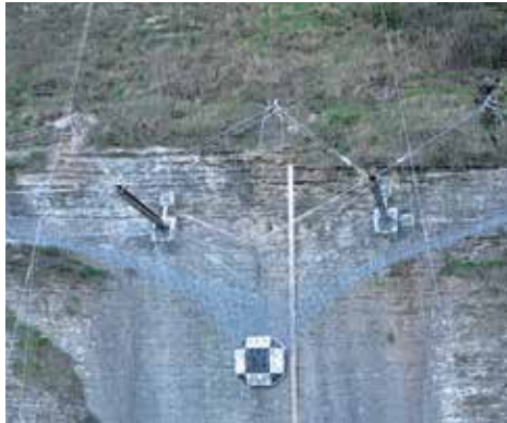
Tam ölçekli kaya düşmesi testi
