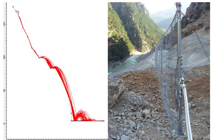
Resim 3. Kaya Bariyeri Enerji Analiz ve 1000kJ Bariyer Uyg.
