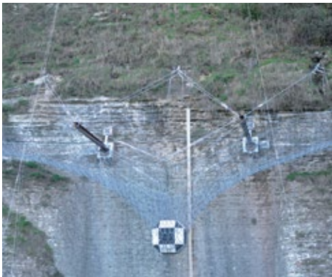
Tam ölçekli kaya düşmesi testi
